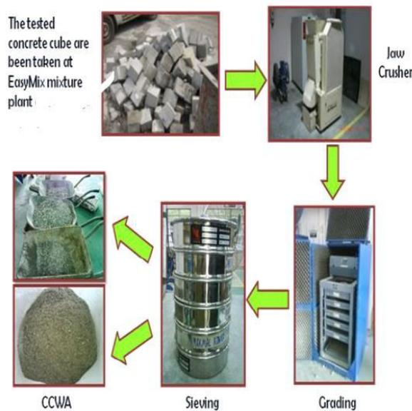
**Fig. 1.** Production of RCA
